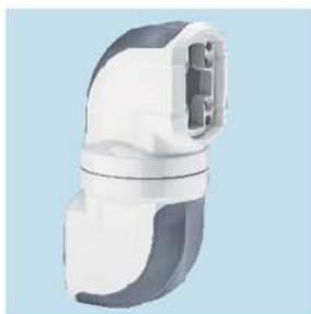
品名:中间连接器 订货号:60-95-330 重量:2.2kg 材料:压铸铝合金 可旋转320°
