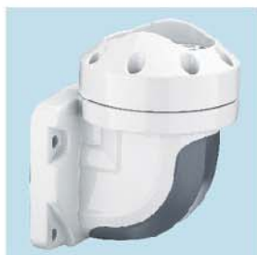
品名:垂直墙座 订货号:75-110-570 重量:5.1kg 材料:压铸铝合金 可旋转320°
