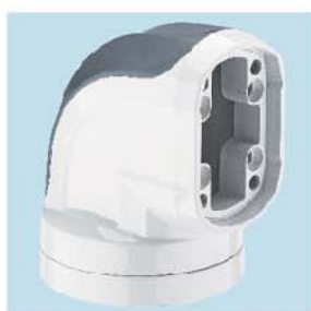
品名:90°箱体连接器 订货号:75-110-550 重量:1.8kg 材料:压铸铝合金 可旋转320°
