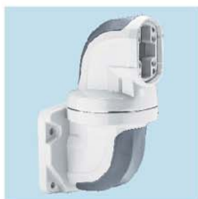
品名:水平墙座 订货号:75-110-560 重量:5.4kg 材料:压铸铝合金 可旋转320°
